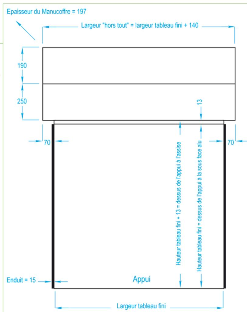
Schéma côté en millimètres
